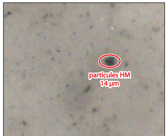
une membrane de 33 µm avec des particules du carbure mesurées
